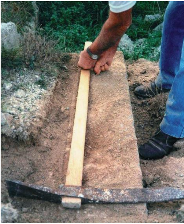
Fig. 6 - Misurazione "a pugni" del blocco in pietra calcarenitica da estrarre con la "zocca"
