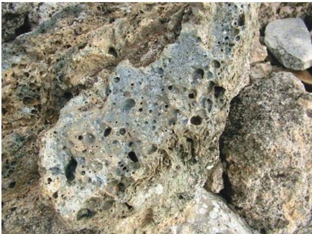
Fig. 14a; 14b - Blocchi calcarei alterati dal calore
